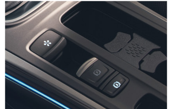
Electronic Parking Brake with Auto Hold Function فرامل يد كهربائية مع نظام تعليق تلقائي لفرامل اليد الكهربائية
